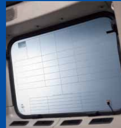
Антенна смонтированная в заднее стекло
