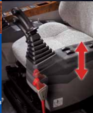
Стойка управления телескопическая
